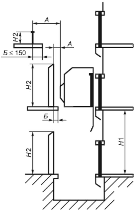
превышает 500 мм, то  $B$  можно последовательно уменьшать до высоты не менее 1100 мм на расстоянии 2000 мм (см. рисунок 2).
